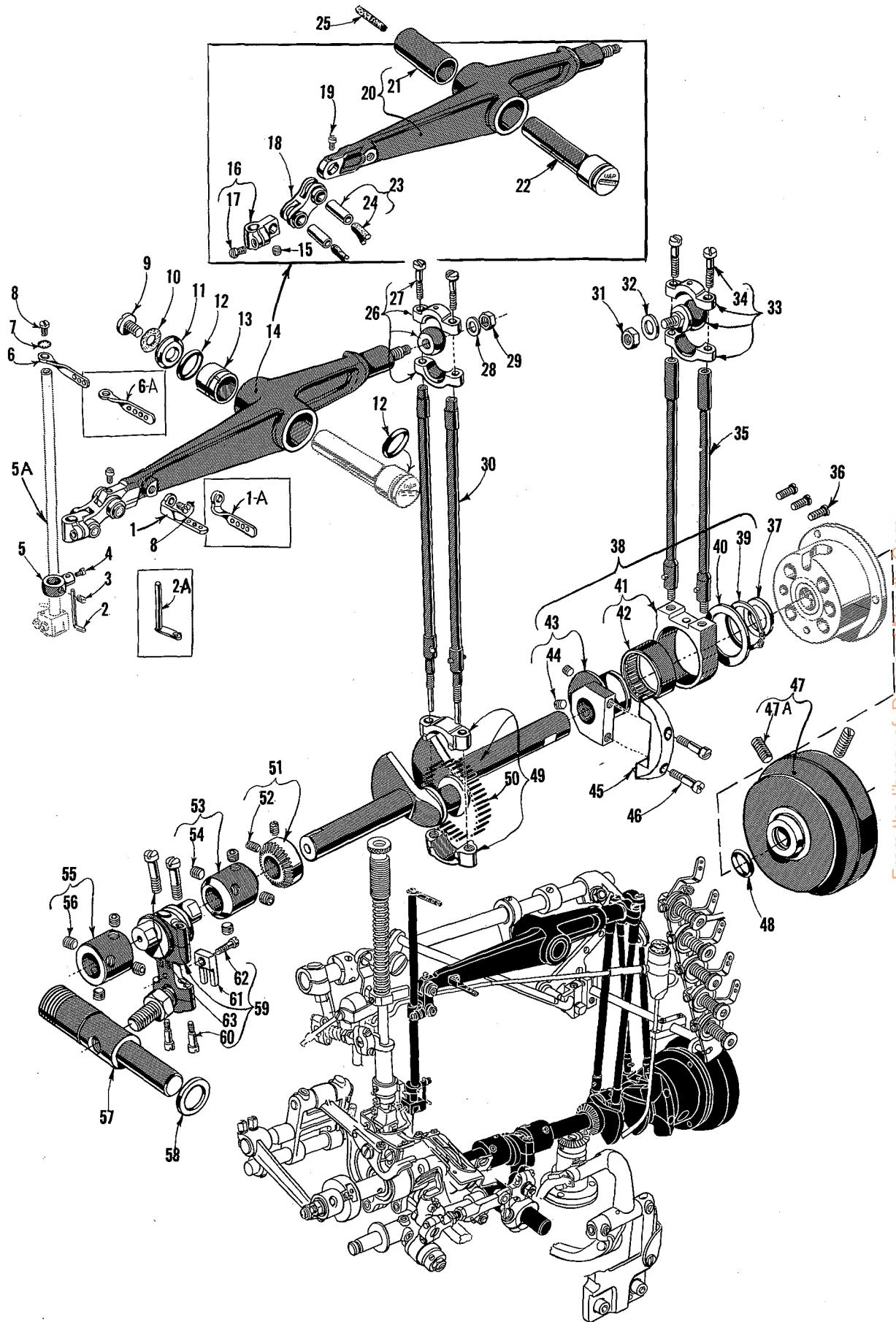
**CRANKSHAFT, NEEDLE LEVER AND LOOPER DRIVING PARTS**
